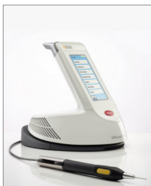
Abb. 7: Sirolaser Advance: Diodenlaser für notwendige Exzisionen und zur Keimreduktion
