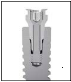
1 | Einbringpfosten mit Implantat vormontiert, Halteschraube angezogen.
