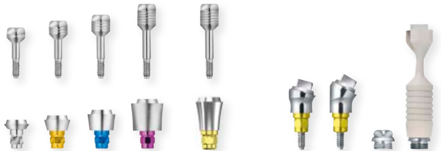
Farbkodierte MP Aufbauelemente (D 3,4 bis 4,5) und MP Insertschrauben. Die Anzahl der Rillen am Schraubenkopf zeigt die Gingivahöhe des passenden Aufbauelements an.
