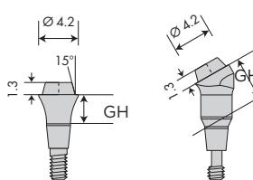
Абатмент Ankylos Balance Base Abutment C/ узкий (вверху) и абатмент Balance Base Abutment C/ угловой (внизу)
